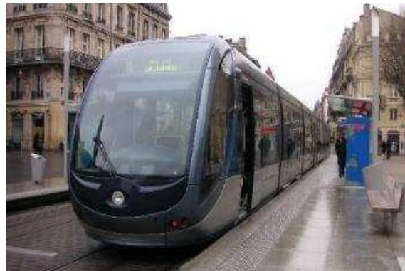
架線レスシステムの例(フランス・ボルドー)
