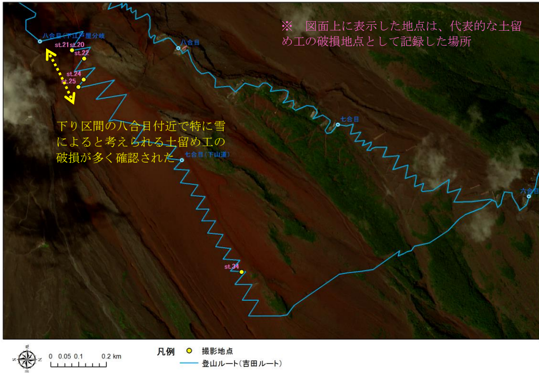
図表 6-16 ①に関する雪による土留め工の破損が見られる区間
