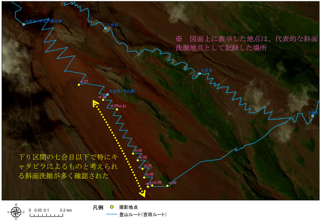
図表 6-20 ③に関する斜面洗掘が見られる区間
